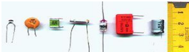
FIG Nº 10 distintos tipos de condensadores y sus tamaños.
