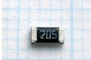
Resistencia de montaje superficial o SMD.
