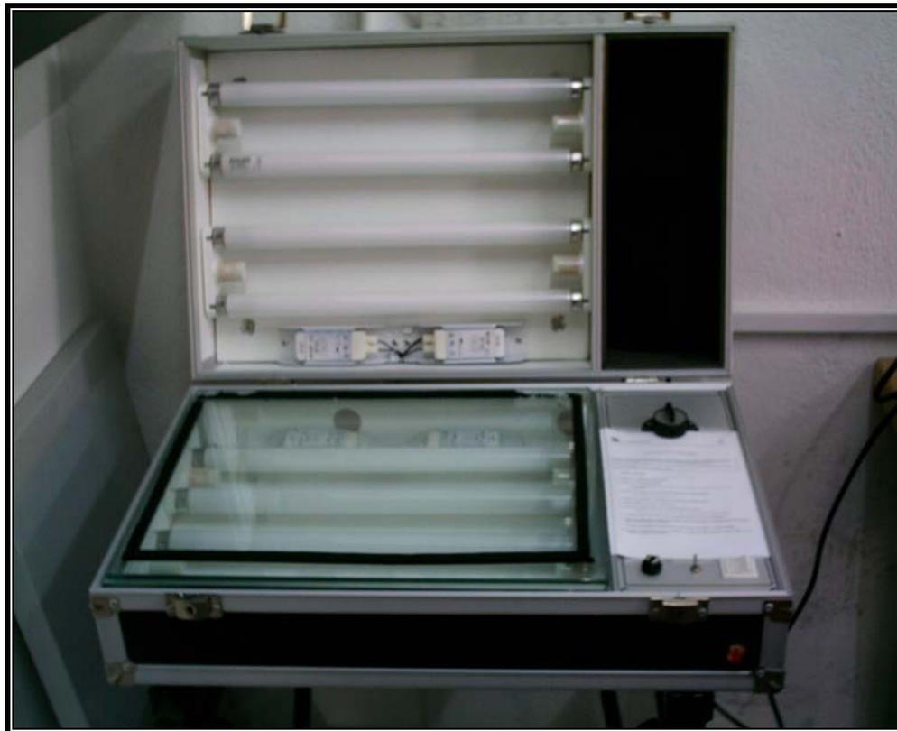
Fig. Insoladora preparada para fotosensibilizar la placa virgen.
