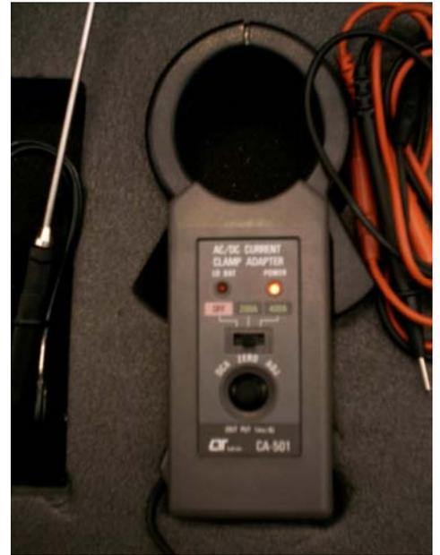
200 A: Se sitúa el selector en la escala de 200 mV, de modo que lo que aparece en el display se lee directamente en amperios.
