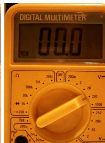
Posición del selector de escalas para medir valores hasta 200 mV.
