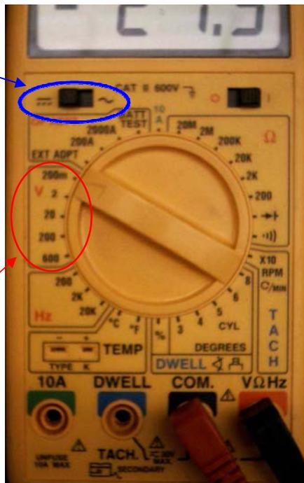
En la zona izquierda se puede observar la escala de medición de tensión.
