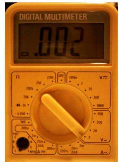
Esta es la posición para medir tensiones alternas hasta valores de 2 V.
