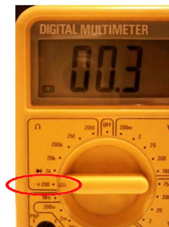
Esta posición sirve tanto para medir resistencias con valores superiores a 200  $\Omega$  e inferiores a 2 K $\Omega$ , como para la verificación de diodos.
