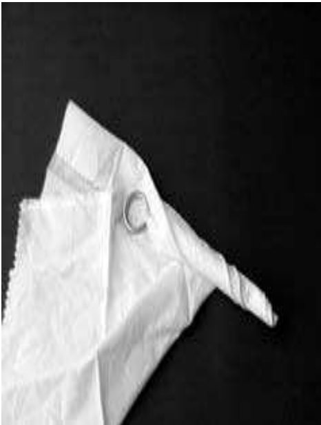
Reflejamos el trapo liado en la varilla Del kit de limpieza
