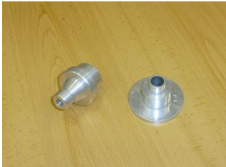
Fig 4. Piezas con cilindros, agujeros, conos y roscas.
