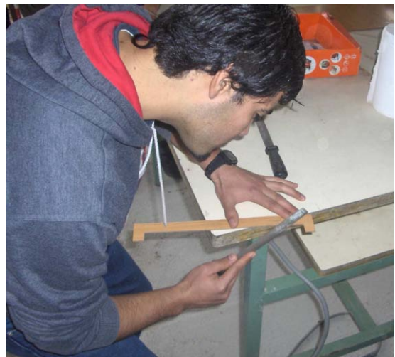
Figura 2 y 3. Alumno fabricando Regla de Christen con caladora y lima
