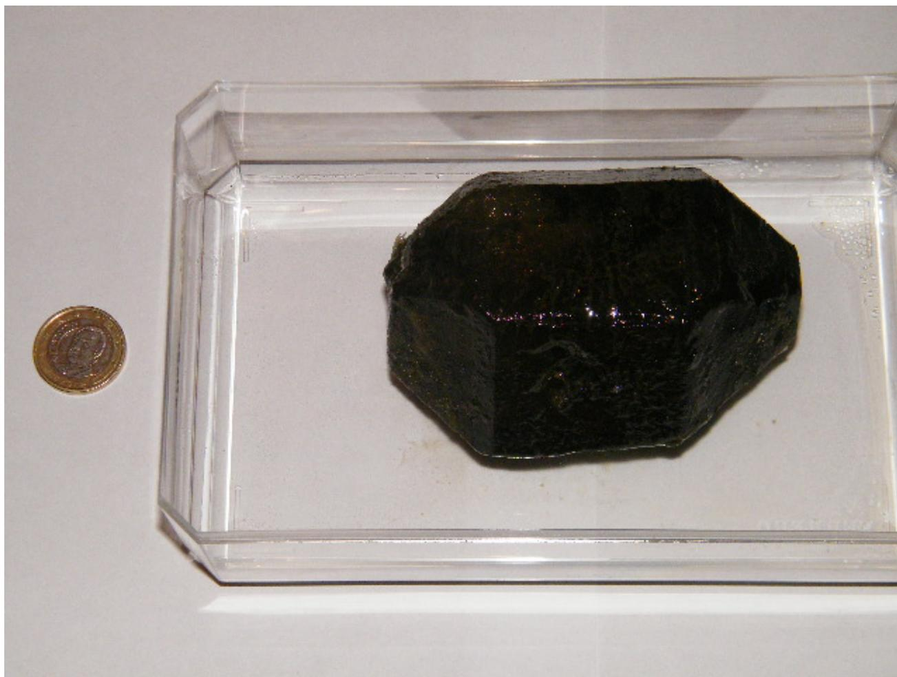
Este cristal es de un mineral llamado Hanksita, este mineral cristaliza de forma natural a partir de disoluciones ricas en la sal de fórmula  $\text{KNa}_{22}(\text{SO}_4)_9(\text{CO}_3)_2\text{Cl}$ . Esta sal hay que conservarla con una película de aceite dado que es una sal que es capaz de disolverse en el agua de la humedad del aire.
