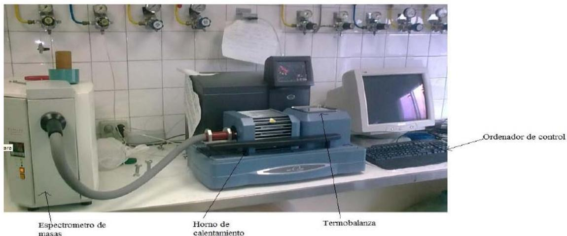
*Figura 1. Equipo de medida del análisis DSC-TGA.*
