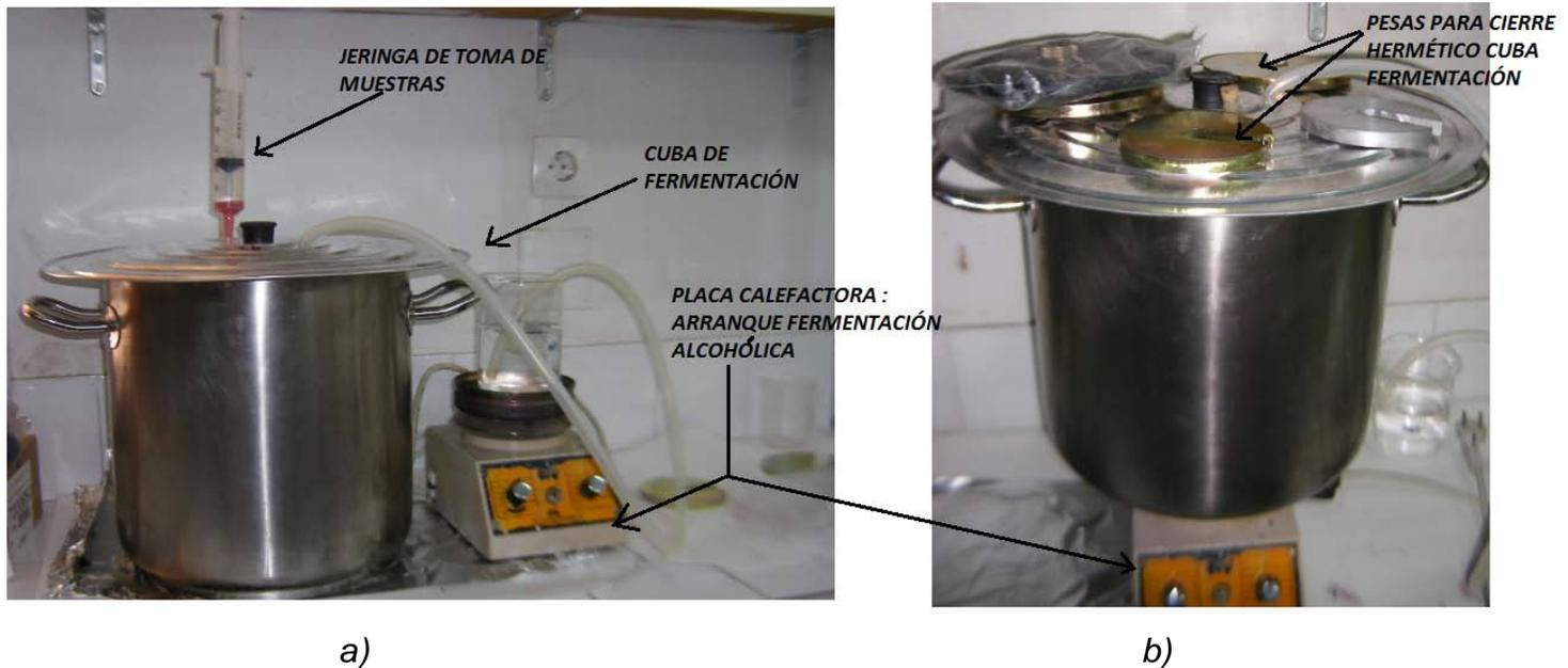
Figura 4. a) Cuba de fermentación en modo toma de muestras, b) cuba de fermentación en el arranque del proceso.
