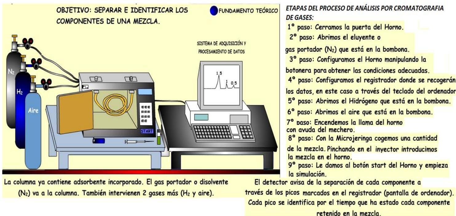
*Figura 7. Análisis de los componentes volátiles de una mezcla mediante cromatografía de gases. Etapas del proceso de determinación.*
