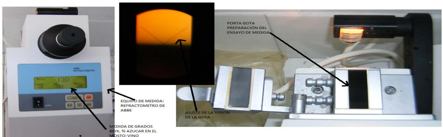
*Figura 5. Descripción del equipo de medida del grado Brix de contenido de azúcar del mosto-vino en el proceso de fermentación*
